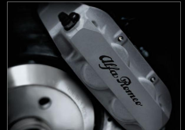
Disques Dual-cast, perforés, autoventilés, 305 x 28 mm (avant), étriers fixes à 4 pistons Brembo<sup>MD</sup>
