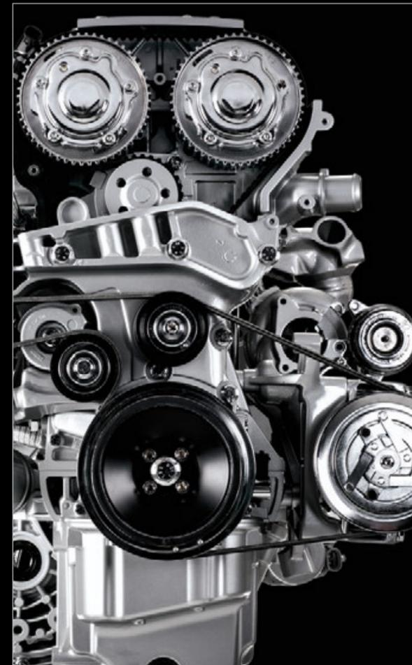
Moteur en aluminium 1750 suralimenté à 4 cylindres en ligne
