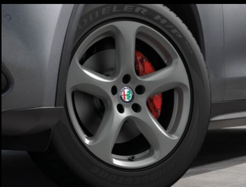
Roues de 18 po en aluminium foncé à cinq rayons Livrables en option sur le modèle Stelvio
