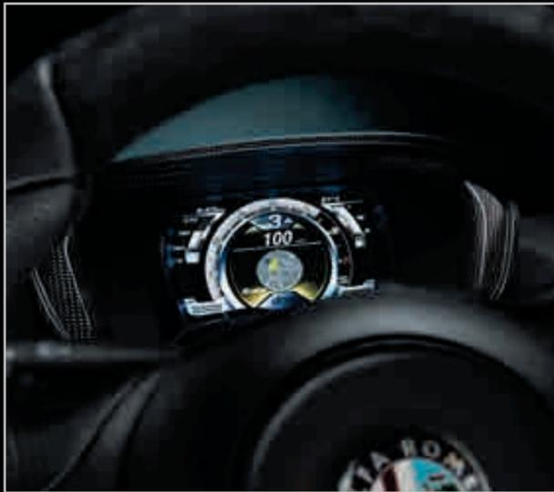
Groupe d'instruments entièrement numérique avec écran à matrice active et enjoliveur en fibre de carbone au groupe d'instruments
