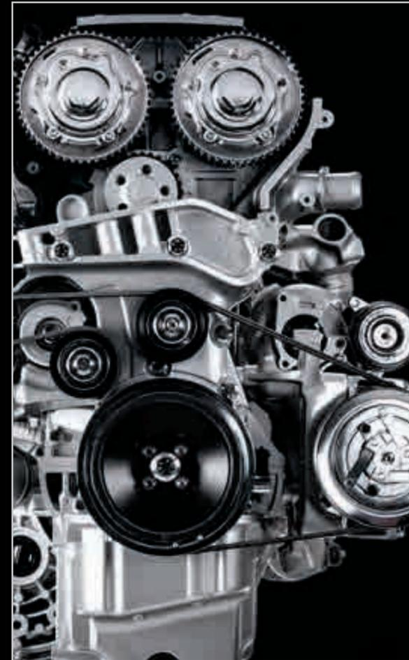
Moteur turbo 4 cylindres en ligne 1750 en aluminium
