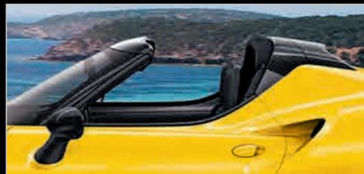
Arceau doté d'une enveloppe de fibre de carbone\*
