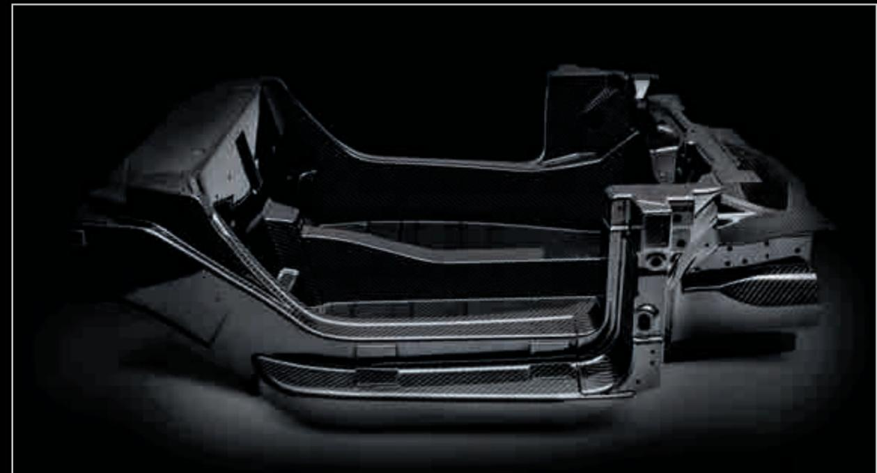
Châssis monocoque en fibre de carbone véritable
