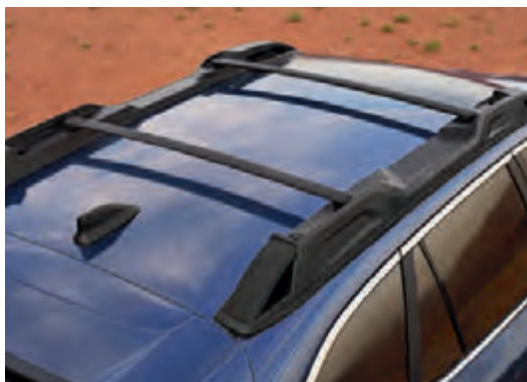
Longerons de toit avec barres transversales escamotables intégrées et crochets d'arrimage
