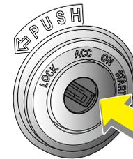
Il est uniquement possible de tourner la clé de la position **ACC** à la position **LOCK** lorsqu'on enfonce la clé en tournant et tandis que le levier sélecteur est à la position **P**.
