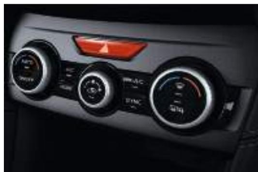
Contrôle de température automatique à deux zones<sup>5</sup>
