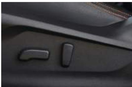
Siège conducteur à réglage électrique<sup>4</sup>
