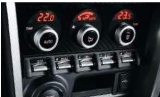
Contrôle de température automatique à deux zones<sup>1</sup>
