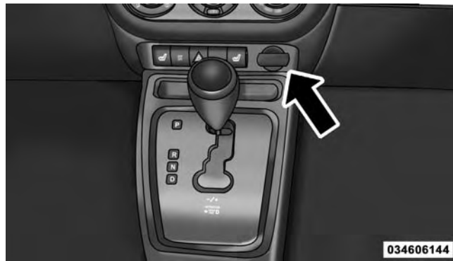
12 Volt Power Outlet
