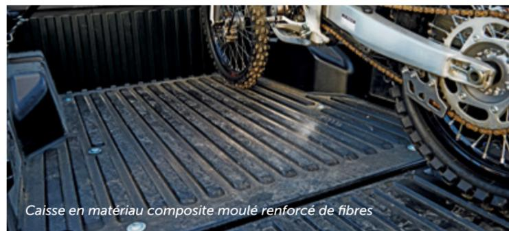
Caisse en matériau composite moulé renforcé de fibres
