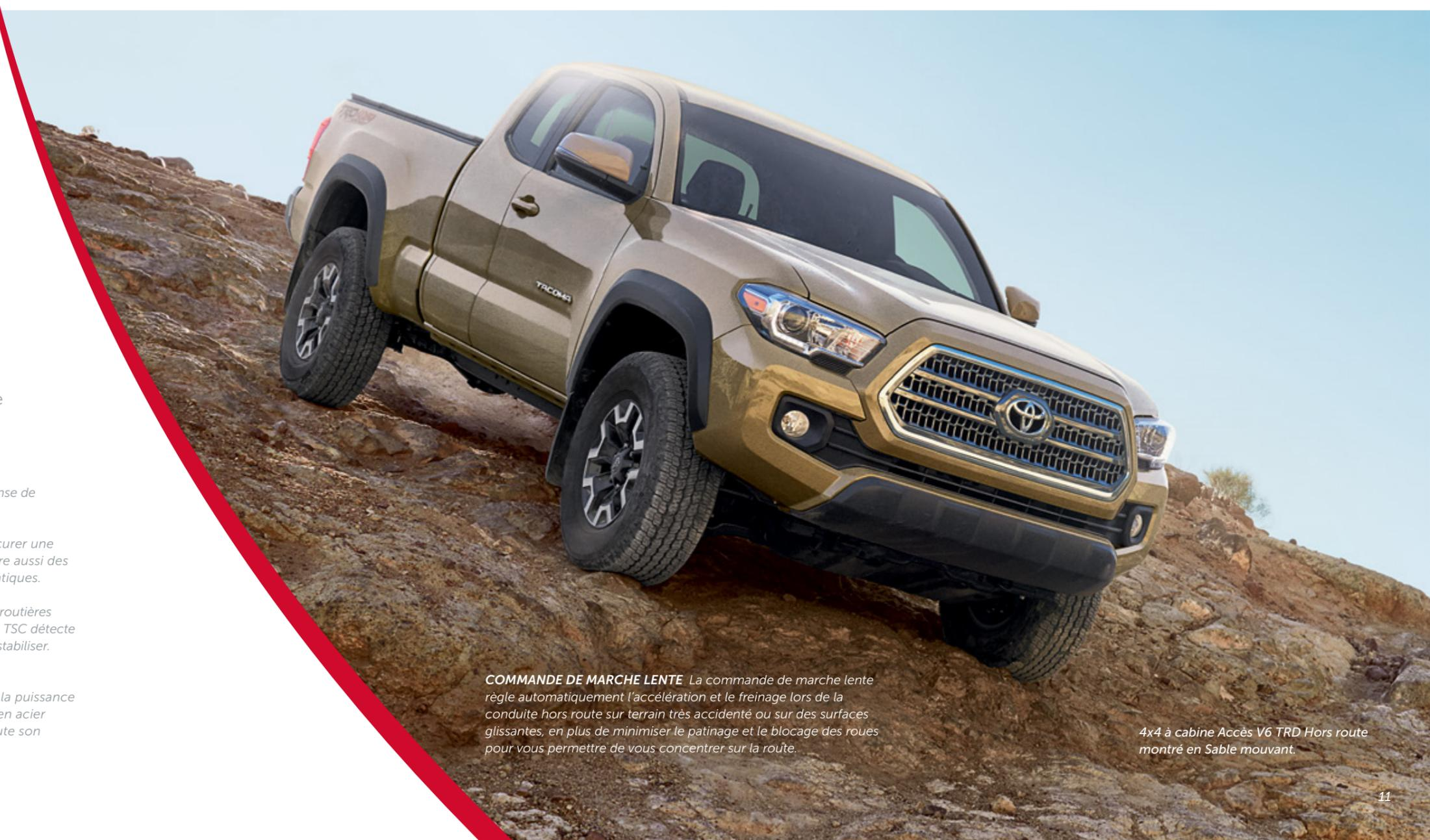
**COMMANDE DE MARCHÉ LENTE** La commande de marche lente règle automatiquement l'accélération et le freinage lors de la conduite hors route sur terrain très accidenté ou sur des surfaces glissantes, en plus de minimiser le patinage et le blocage des roues pour vous permettre de vous concentrer sur la route.
