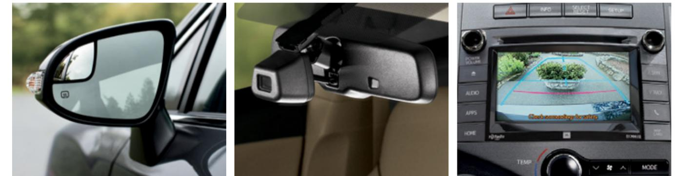
**RÉTROVISEURS À ANGLES MORTS CONVEXES** Les rétroviseurs à angles morts convexes élargissent le champ de vision à droite et à gauche, permettant de voir si une autre voiture arrive sur l'un des côtés.
