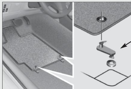
Utiliser uniquement les crochets de retenue d'origine spécifiés. Les crochets d'origine ne sont pas tous pareils.
